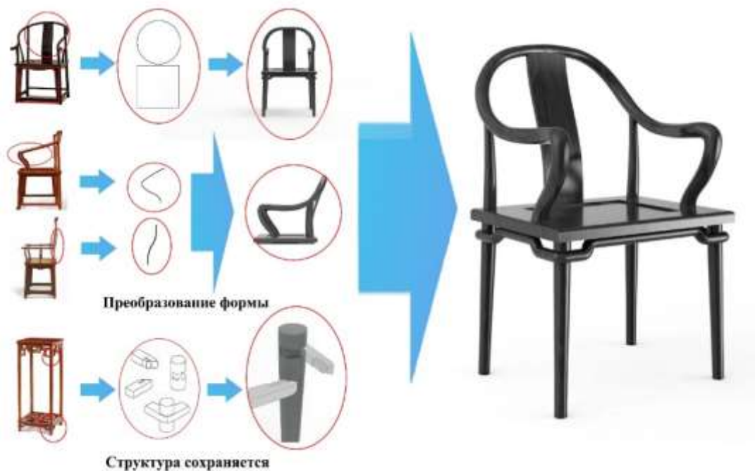
Рис. 2. Проект 2. Трансформация формы и структуры стула с эргономичной S-образной спинкой
